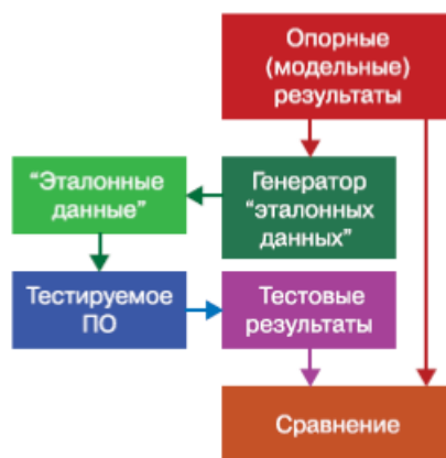
Рис.3 Тестирование ПО с использованием генерации "эталонных данных"
