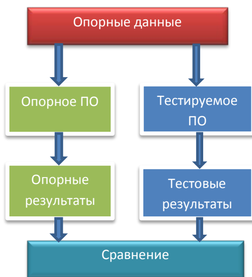
Рис.2 Тестирование ПО с использованием опорного "эталонного" программного продукта
